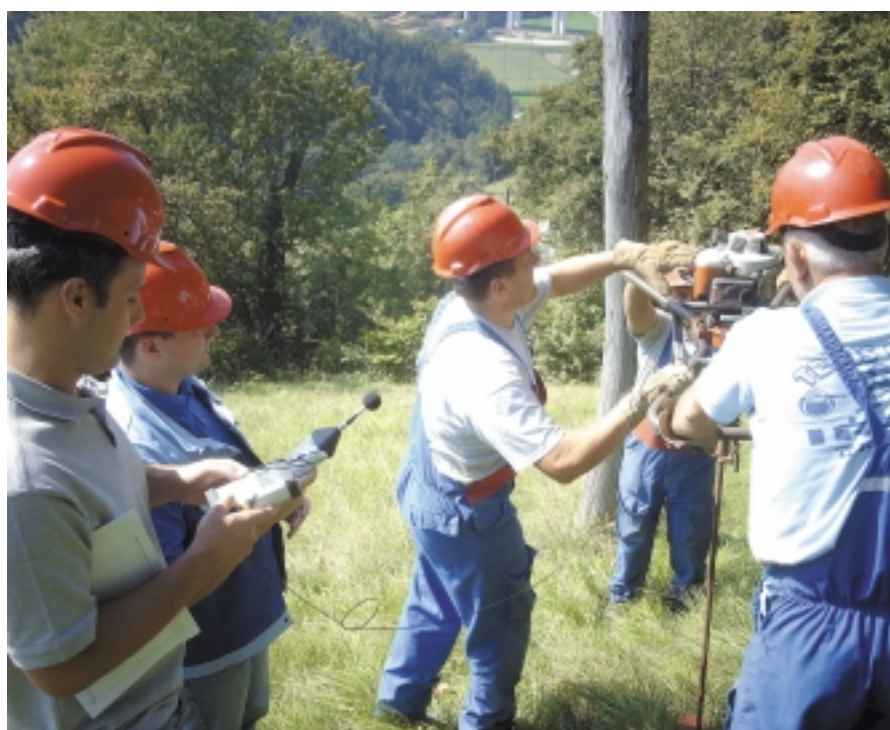
Izvedba meritev hrupa in vibracij na terenu, in sicer na zemeljskem vrtnem stroju.
