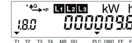
1.8.0 - porabljeni delovni električni energija pri enotarifnem merjenju, v tem primeru 9,8 kWh.
