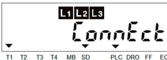
Na prikazovalniku števca se po odklopu prikaže napis »ConnEct».
