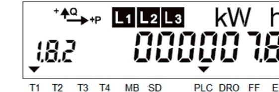
1.8.2 - porabljeni delovni električni energija pri dvotarifnem merjenju v manjši tarifi (T2), v tem primeru 7,8 kWh.
