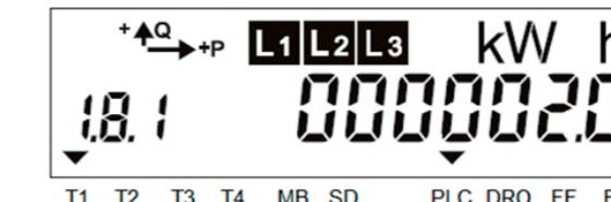
1.8.1 - porabljeni delovni električni energija pri dvotarifnem merjenju v višji tarifi (T1), v tem primeru 2,0 kWh.
