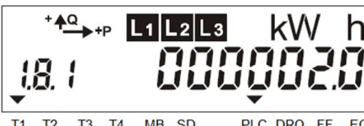
1.8.1 — porabljena delovna električna energija pri dvotarifnem merjenju v višji tarifi (T1), v tem primeru 2,0 kWh.
