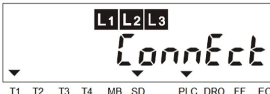
Na prikazovalniku števca se po odklopu prikaže napis »ConnEct«.
