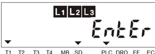
Tipko držite približno 5 sekund, dokler se ne prikaže napis »EntEr«, nato tipko izpustite in zaslišali boste vklop odklopnika. Tipko spustite tudi takrat, ko zaslišite vklop odklopnika, čeprav se ne izpiše »EntEr«.
